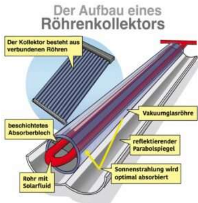
Abbildung 28: Aufbau eines Röhrenkollektors
