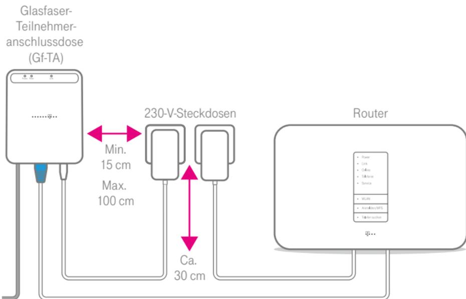
**Ein Anschluss für alles.** An die Glasfaser-Teilnehmeranschlussdose (Gf-TA) können Sie den Router und daran alle Telekommunikations- und Multimedia-Geräte anschließen.
